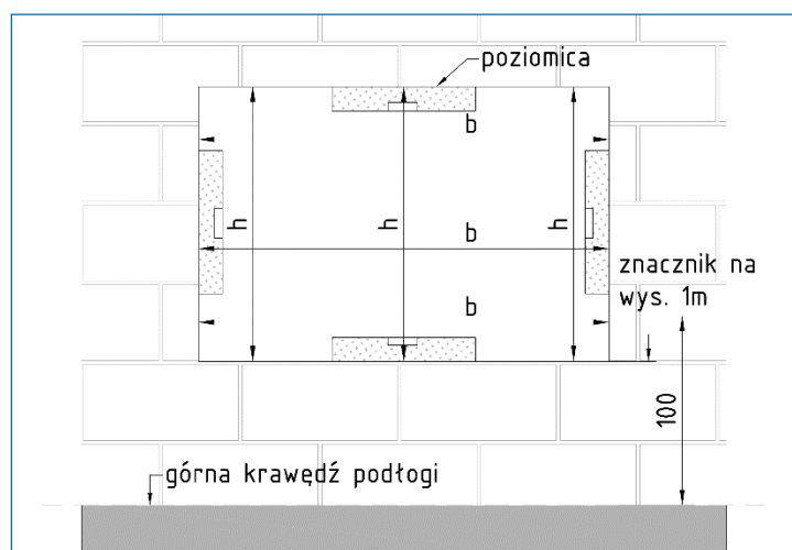
Rys. 2 Sposób pomiaru otworu okiennego
